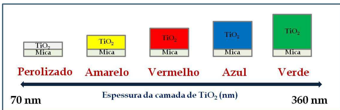
Figura 2.18 – Progressão da cor vs. espessura da camada de cobertura ( TiO_2 sobre mica).
