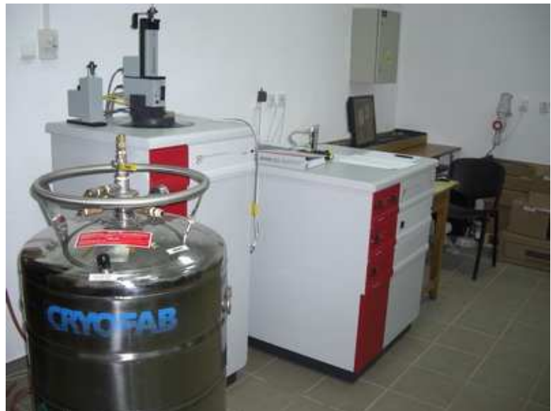
Figura 3.6 – Magnetômetro SQUID da Quantum Design , utilizado nas medidas de magnetização.
