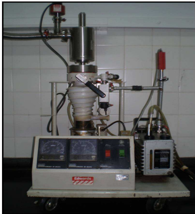
Figura 3.2 – Sistema de alto-vácuo (i.e., bomba mecânica mais difusora), utilizado nos tratamentos térmicos em vácuo.
