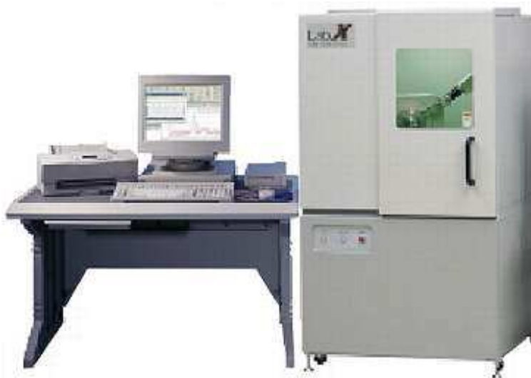
Figura 3.5 – Difratômetro automático da Shimadzu (XRD-6000), utilizado nas medidas de DRX.
