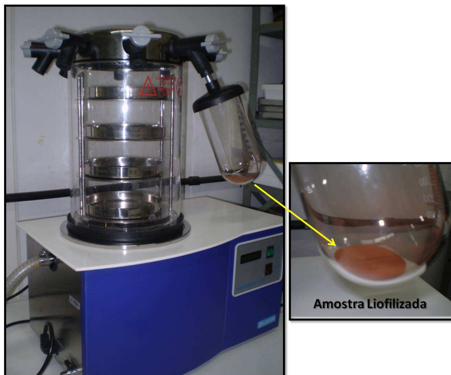
Figura 3.4 – Liofilizador utilizado no recobrimento de nanopartículas de ferro.
