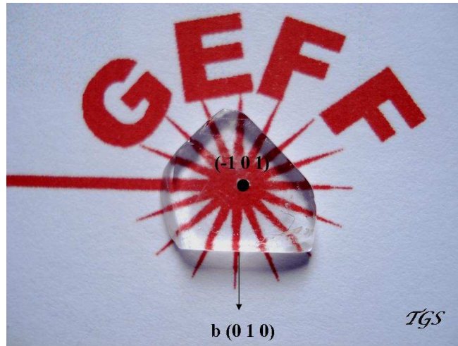
Figura 3.9 Orientações do TGS determinadas por Raios-X. O feixe laser incidente é S//(-1\ 0\ 1) .
