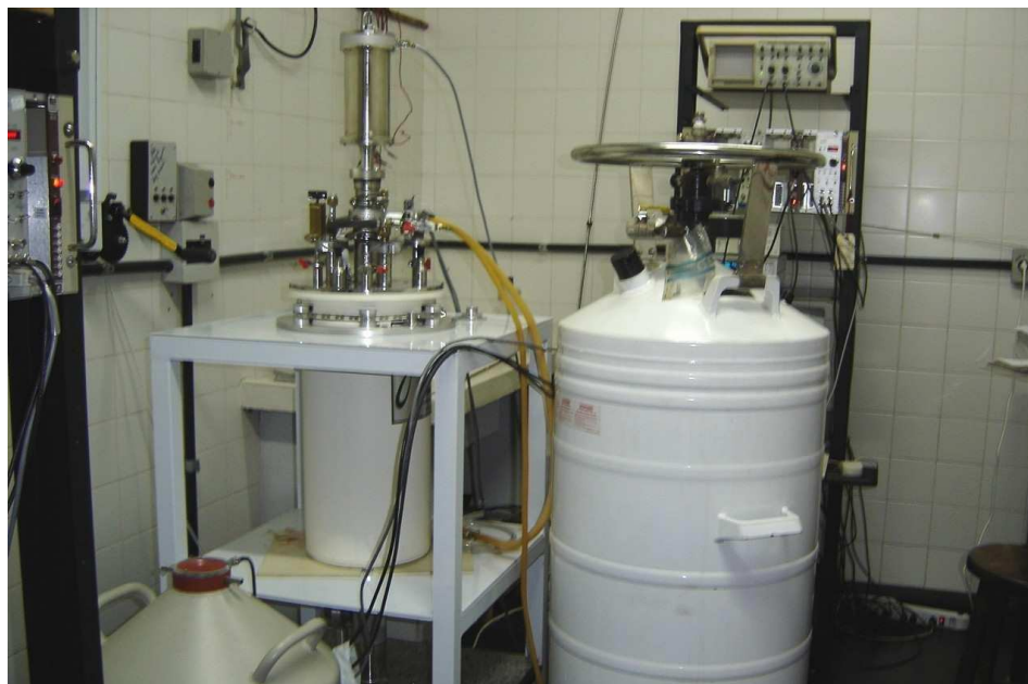
Figura 3.7 – Criostato e reservatório de Hélio. O arranjo na foto é específico para a espectroscopia Mössbauer no ^{155}\text{Gd} .
