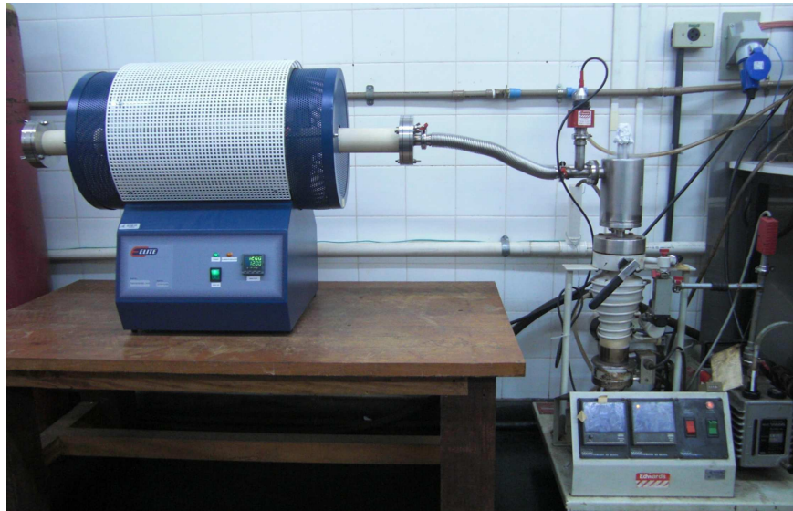
Figura 3.3 – Forno tubular utilizado para tratamentos térmicos em T > 1100^{\circ}\text{C} .
