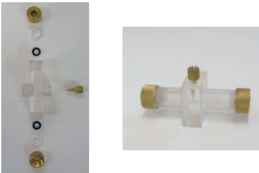
Figura 4.26. A esquerda temos a foto das partes que compõem o conector dos tubos, e a direita o conector montado.
