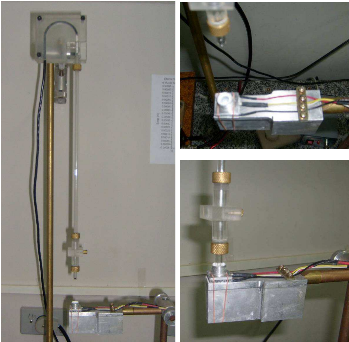
Figura 4.29. A esquerda temos a foto do conjunto montado, onde vemos a célula acústica completa. A direita vemos fotos de como se realiza o encaixe do porta-amostra com o sistema de variação de temperatura da amostra.
