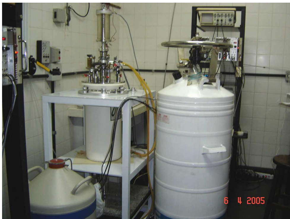
Figura 4.5: Montagem experimental utilizada para medidas Mössbauer em baixas temperaturas.
