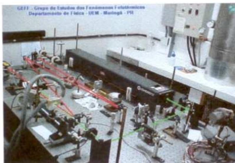
Figura 4.2: Arranjo experimental para espectroscopia de lente térmica.
