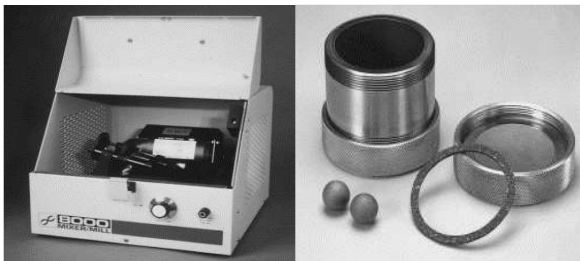
Figura 3.3: Moinho Spex e vaso de moagem (BIONDO, 2005).
