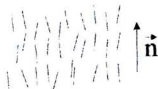
Figura 1.3.1: Representação esquemática da ordem molecular na fase nemática e a orientação de seu diretor
