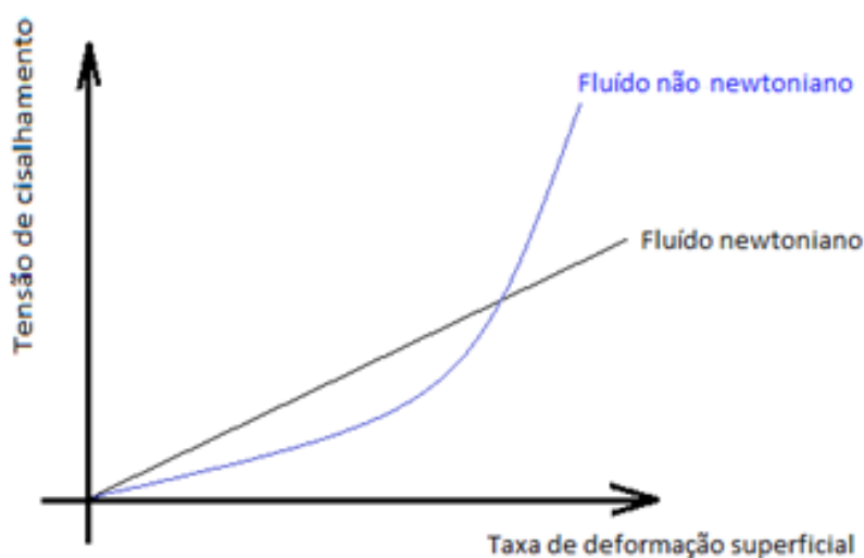
Fig.1.1 - Figura ilustrativa da relação entre tensão de cisalhamento e taxa de deformação superficial típicos de um fluído newtoniano e não newtoniano.
