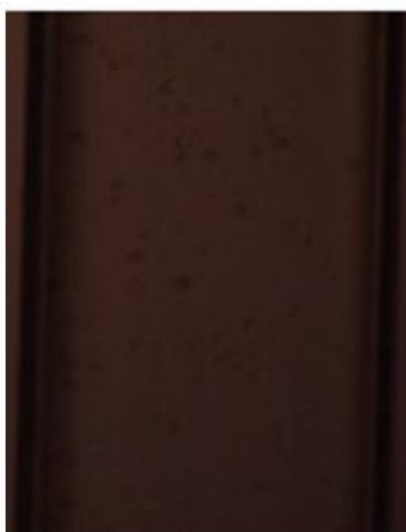
Fig.3.5 - Textura típica da fase isotrópica, foto tirada na temperatura de 23°C da amostra 2 da tabela 3.1, foto foi ampliada 50X.
