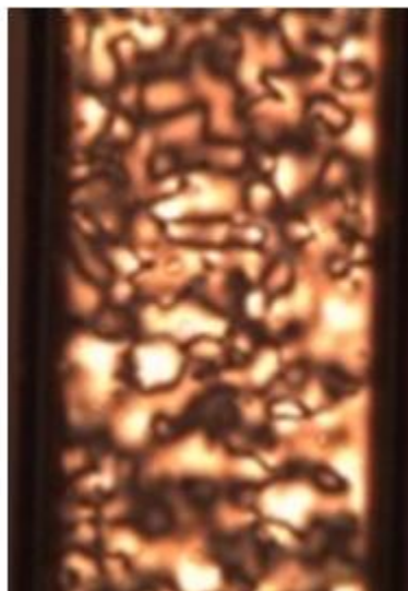
Fig.3.7 - Textura da fase nemática uniaxial discótica - não orientada - em T=23^{\circ}\text{C} da amostra 4 da tabela 3.1, ampliada 50X e observada em capilar de 200\mu\text{m} .
