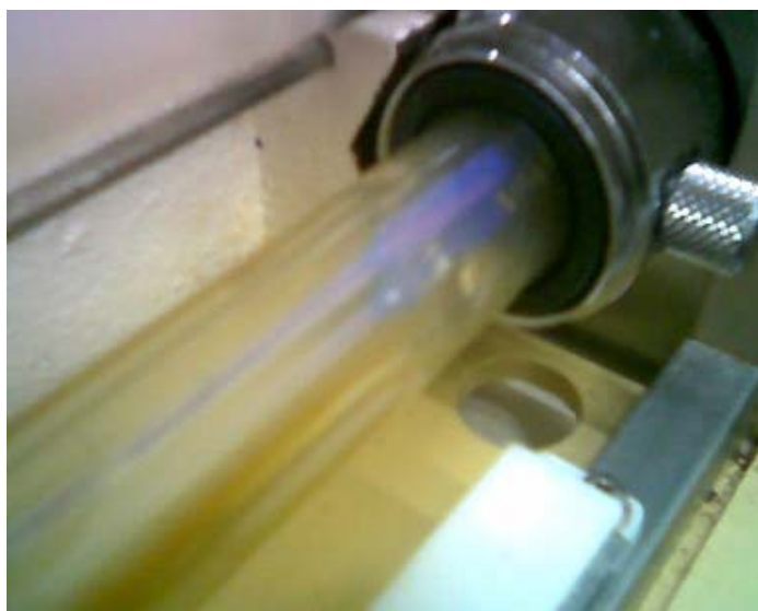
Figura 3.4: Foto do tubo capilar do densímetro com a amostra de COC na região de temperatura da “blue phase”.
