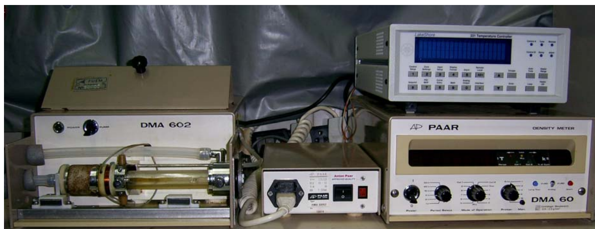
Figura 3.3 : Equipamento utilizado para realizar medidas de densidade
