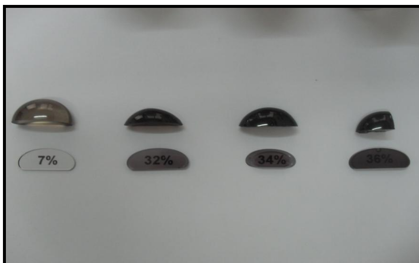
Figura 43: Foto das amostras do vidro aluminossilicato de cálcio com 2% \text{TiO}_2 e X% \text{SiO}_2 (X=7, 32, 34 e 36). As proporções são relativas à massa.
