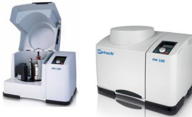
Figura 5.1: Moinho planetário Retsch PM 100 utilizado no processo de moagem.
