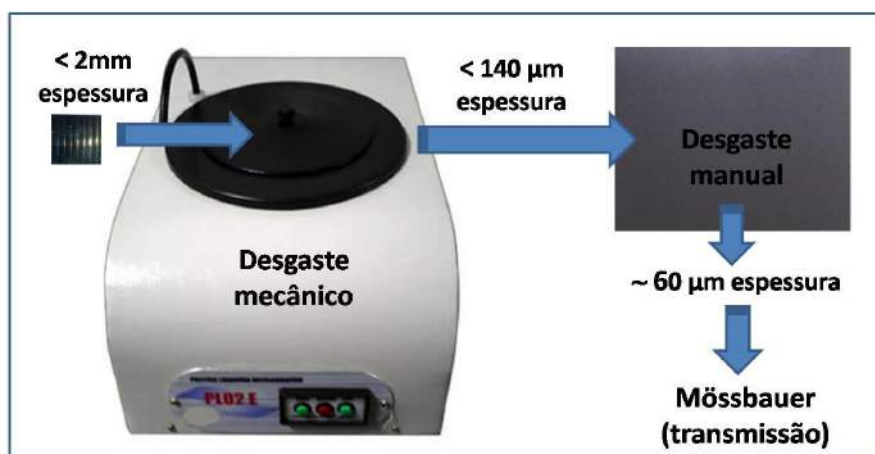
Figura 31 Esquema da lixadeira mecânica utilizada para o método de afinação das amostras.
