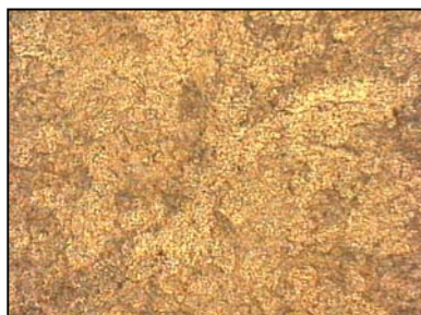
Figura 4.4: (b) Microfotografia da textura do cristal líquido (7OBAC) na região de transição C – N_1 ( T = 96^\circ C ).
