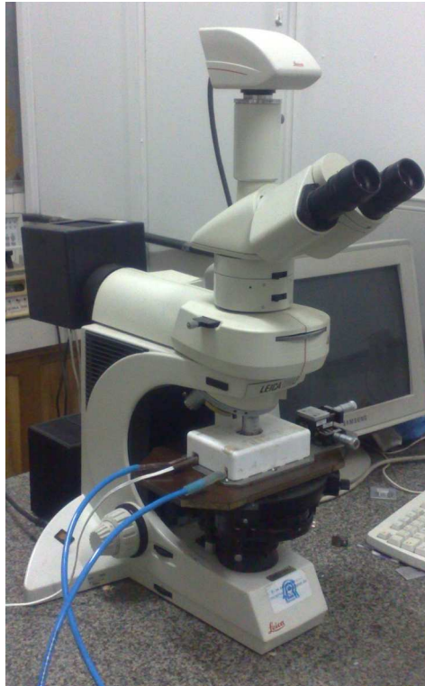
Figura 3.3: Foto do sistema (microscópio óptico de luz polarizada, câmera digital e hotstage ) utilizado para caracterização das texturas e mesofases.
