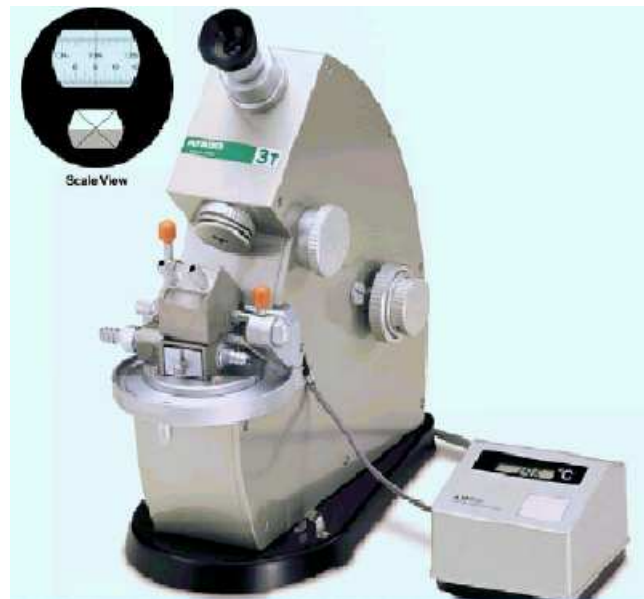
Figura 3.6: Refratômetro de Abbe utilizado para medir os índices de refração dos cristais líquidos. No canto superior à esquerda se observa a imagem vista pela ocular, ilustrando uma fronteira claro/escuro que deve ser focalizada primeiramente no centro do x, e consequentemente, é feita a leitura do índice de refração através da escala.
