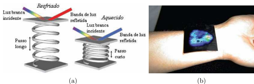
Figura 1.6: (a) O passo da hélice da mesofase colestérica assemelha-se à uma mola, aumentando e diminuindo de tamanho quando resfriado e aquecido, respectivamente. As diferentes tonalidades de cores refletidas dependeram somente do tamanho da hélice. (b) Demonstração de mudanças de cores em contato com temperatura corpórea [6].
