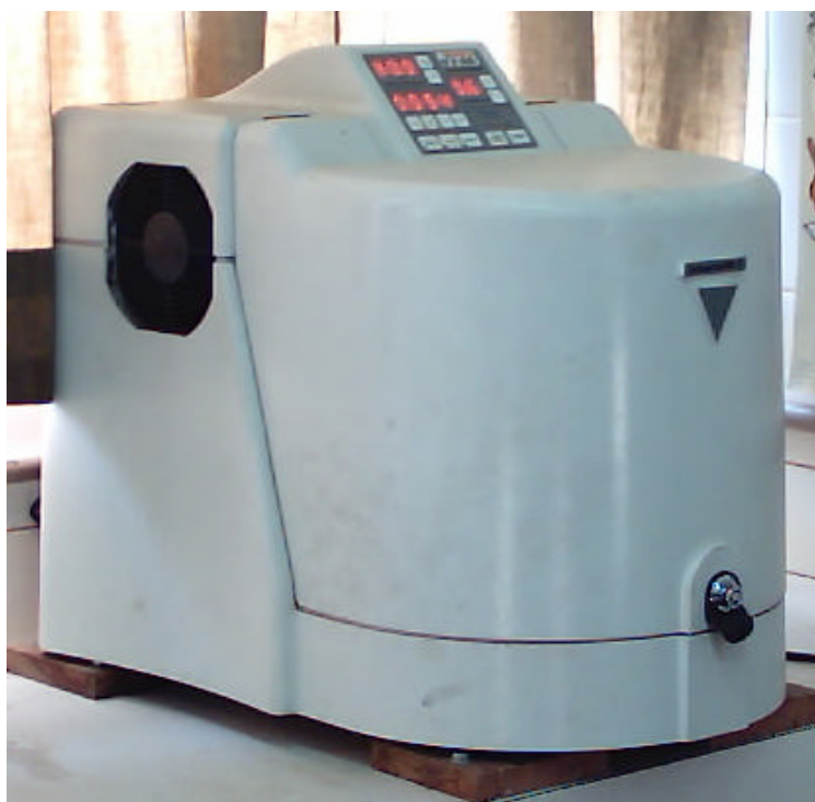
Figura 4.1.1: Moinho de bolas Fritsch, modelo Pulverisette 6.
