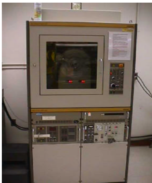
Figura 4.2.1: Difratômetro de Raios – X, da marca Siemens, modelo D-500.
