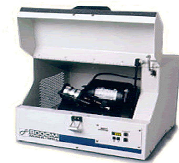
Figura 2.3.1: Moinho vibratório, modelo 8000M da empresa SPEX.
