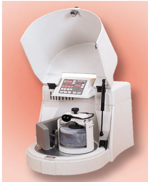
Figura 2.3.3: Moinho planetário da marca Fritsch, modelo Pulverisette 6.
