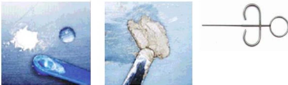
Figura 1.4 (a)- A pá dosadora mede a quantidade do pó de MTA necessária, 200mg para cada 57 µL de água [29] . (b)- A água endurece o pó de MTA formando a massa que será aplicada na boca humana para aplicações clínicas [29] . (c)- A agulha de Gilmore é utilizada para verificar o tempo de presa do MTA [29]
