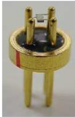
Figura 2.5 - Sensor de estado sólido usado para detectar mais de 100 gases tóxicos (CHOU, 2000).
