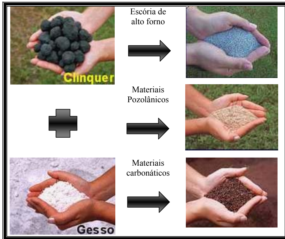
Figura 3.1: Aspecto físico do clínquer antes e depois da mistura com as adições de escória, pozolana e materiais carbonáticos [14] .
