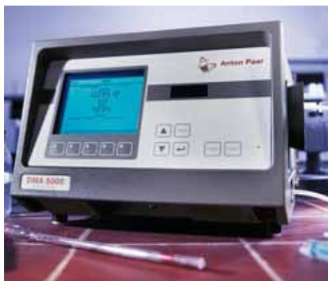
Figura 3.9: Densímetro digital ANTON PAAR – DMA 5000. Equipamento usado na determinação dos transientes de densidade dos ORMCA e dos ORMSA.
